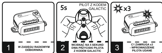
Rys. 5. Wpisywanie pilota z funkcją Galactic do odbiornika
