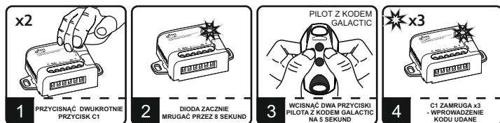
Rys. 4. Wprowadzenie kodu uwierzytelniającego funkcji Galactic do odbiornika.
